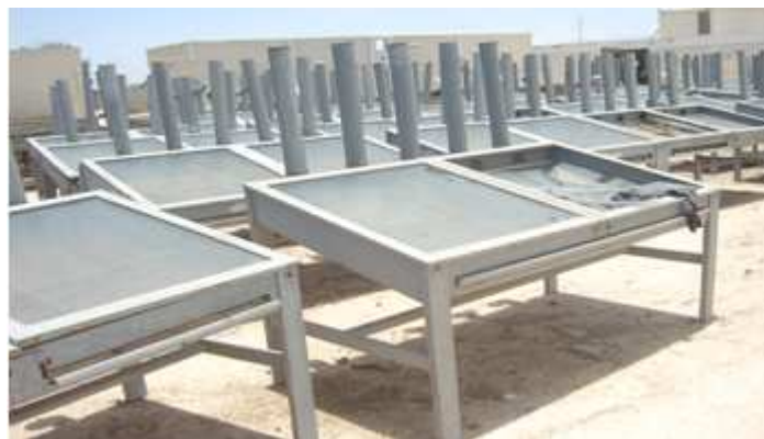
Figure 16: Photo de séchoirs solaires passifs directs en boîte avec cheminée au site de l'hydrobase à Saint-Louis
